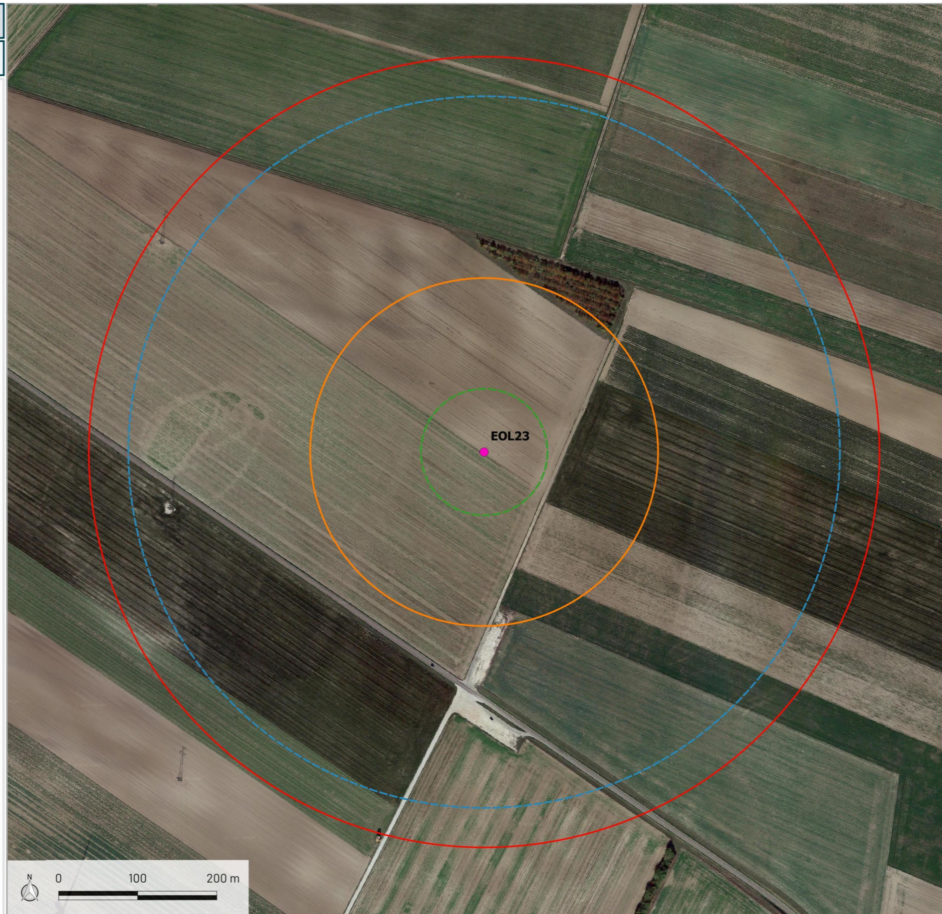
Carte 18: Niveau de risque pour l'éolienne EOL23
